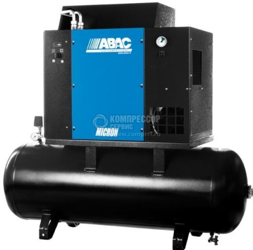
**ЦЕНА:****0 р?** руб.Производитель **ABAC** ()Вид оборудования **Винтовой компрессор**Производ-ть, л/мин **557 / 641**Давление, бар **8 / 10**Мощность, кВт **5**Объем ресивера, л **270**На ресивере **да**С осушителем **нет**Напряжение, В **380**Тип двигателя **Электродвигатель**Тип привода **ременной**Безмасляный **нет**С частотником **нет**Тип компрессора **Стационарный**Охлаждение **Воздушное**Габариты, мм **1550x680x1280**Вес, кг **137**
